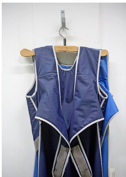
Mit Röntgenschürzen schützen sich die Mitarbeiter vor der Strahlung.
